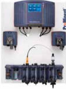
Sistema completo DULCODOS Pool Soft para el ajuste del valor de pH y para la desinfección con oxígeno activo y sin cloro. Para evitar que los gérmenes presentes en la piscina desarrollen resistencia al oxígeno activo la dosificación no se realiza de forma continua sino como un tratamiento de choque controlado por un temporizador. Alternativamente se puede realizar la regulación por sensor.
