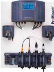
Sistema completo DULCODOS Pool Comfort con regulador DULCOPOOL Pro para el ajuste del valor de pH y para la desinfección con productos de cloro líquidos. En función de los requisitos y del volumen de circulación se utilizan bombas peristálticas de la serie DULCOFLEX, bombas dosificadoras a motor tipo alpha o bombas dosificadoras magnéticas tipo beta.
